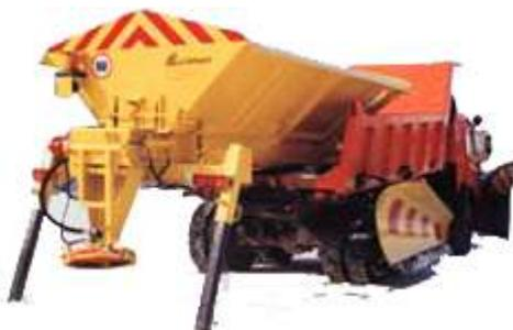
**Средний отвал (марка ОСА)** с дополнительным выдвижным крылом. Оснащен специальными ножами, позволяющими не снижая скорости произвести разработку наледи и наката. В летний период отвал используется для планирования сыпучих материалов при строительстве и ремонте автомобильных дорог. Механизм регулировки по высоте позволяет изменять угол резания ножа.
