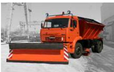
ДМК-50 - комбинированная дорожная машина на базе шасси автомобиля КамАЗ-53605 с комплектом быстросъемного навесного оборудования предназначена для круглогодичного содержания автомобильных дорог с твердым покрытием. Комплектация по выбору Заказчика. Монтаж в условиях Заказчика.
