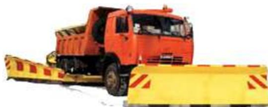
**Передний поворотный отвал (марка ОПАГ)** с резиновыми ножами предназначен для очистки автодорог от свежес выпавшего снега, шуги и отработавших противогололёдных материалов. Легко монтируется взамен скоростного отвала ОПА. Удобен при эксплуатации в городских условиях.
