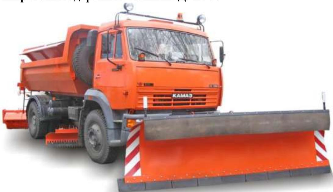
**Комбинированные дорожные машины ДМК-60** - это маневренный с хорошими тяговыми усилиями автомобиль-самосвал КАМАЗ-53605 с комплектом быстросъемного взаимозаменяемого навесного оборудования для зимнего и летнего содержания автомобильных дорог, городских улиц, производственных территорий, а также для перевозки сыпучих и прочих грузов. Грузоподъемность 11т.
