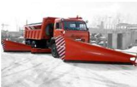
Универсальная дорожная машина для зимнего и летнего содержания автомобильных дорог на базе специально созданного большегрузного автомобиля-самосвала КАМАЗ-53229 с удлиненной усиленной рамой и плоским кузовом повышенной грузоподъемности. Комплектация по выбору Заказчика.
