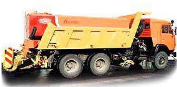
**Щётка уборочная (марка ЩУ-4)** предназначена для очистки автодорог от мусора, свежесвалившегося снега, шуги, слякоти и отработавших противогололёдных материалов. Привод щётки - гидравлический. Конструкция гидравлической. Устанавливается сзади машины под углом 30° исключает попадание мусора и агрессивных материалов на силовые агрегаты. Монтаж и демонтаж осуществляется за 15-20 минут.
