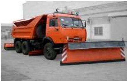
Универсальная дорожная машина для зимнего и летнего содержания автомобильных дорог, для перевозки сыпучих и прочих грузов. Создана на базе автомобиля-самосвала КамАЗ-55111 с комплектом быстросъемного навесного оборудования. По конструкции устанавливаемого оборудования машина относится к типу скоростных дорожных машин.
