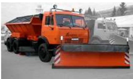
Универсальная комбинированная дорожная машина ДМК-80 представляет собой шасси КАМАЗ-53215 с комплектом быстросъемного навесного оборудования для зимнего и летнего содержания автодорог. По конструкции устанавливаемого оборудования машина относится к типу скоростных дорожных машин.
