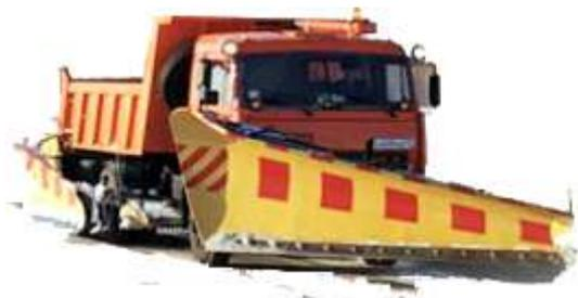
**Передний скоростной отвал (марка ОПА)** предназначен для уборки снега в патрульном режиме. Обеспечивает сбрасывание снега с дорожного полотна на расстояние не менее 20 м без образования снежного вала на обочине и эффекта забрасывания на кабину, имеет регулируемые по высоте пневматическое опорное колесо с левой стороны и лыжную опору с правой.
