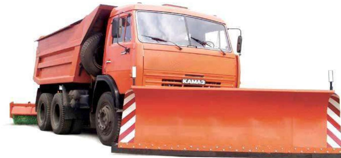
**ДМК-30** - универсальная дорожная машина для зимнего и летнего содержания автомобильных дорог, для перевозки сыпучих и прочих грузов. Создана на базе автомобиля-самосвала КамАЗ-55111 с комплектом быстросъемного навесного оборудования. По конструкции устанавливаемого оборудования машина относится к типу скоростных дорожных машин. Управление всем оборудованием – электрогидравлическое из кабины водителя. Комплектация по выбору Заказчика. Монтаж в условиях Заказчика.
