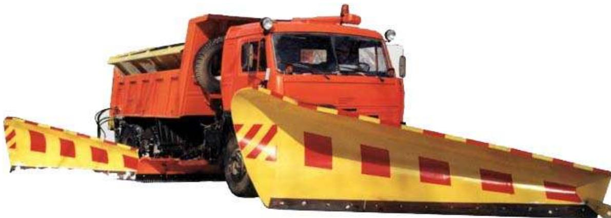
**ДМК-40** - универсальная дорожная машина для зимнего и летнего содержания автомобильных дорог на базе специально созданного большегрузного автомобиля-самосвала КАМАЗ-53229 с удлиненной усиленной рамой и плоским кузовом повышенной грузоподъемности.
