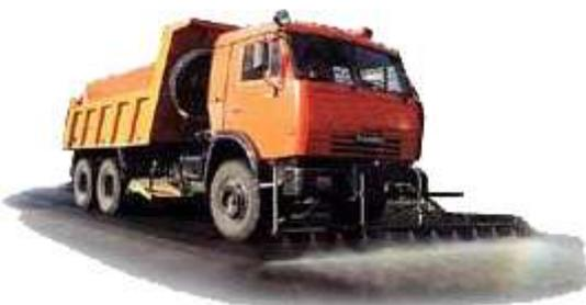
**Поливомоечное оборудование (марка ПМО)** самоустанавливаемое в кузов самосвала без применения грузоподъемных механизмов. Предназначено для мойки дорожной одежды и обстановки поворотной струйной гребёнкой. Оснащено водяным насосом высокого давления. Предусмотрено устройство для мойки дорожных знаков и прочей обстановки.
