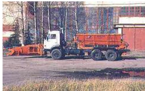
Комплексная дорожная машина КДМ-313 предназначена для ямочного ремонта асфальтобетонного покрытия автодорог в весенне-летний период и проведения работ по зимнему содержанию автодорог в осенне-зимний период.
