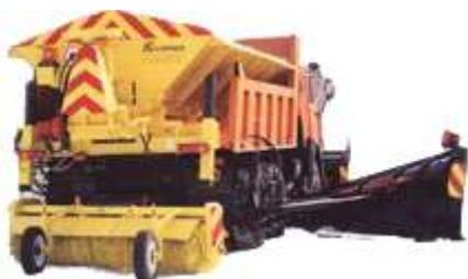
**Пескосолераспределитель (марка РПМ)** самоустанавливаемый в кузов самосвала без применения грузоподъемных механизмов. Обеспечивает безопасное распределение противогололедных материалов с возможностью регулирования по высоте разбрасывающего диска, ширине и направлению посыпки. Оборудован специальным устройством для полной загрузки бункера и исключая зависание смеси на его стенках.
