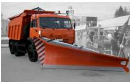
Универсальная комбинированная дорожная машина ДМК-70 представляет собой автомобиль-самосвал КАМАЗ-65115 (Грузоподъемность 15 тонн, мощность двигателя 260 л.с.) с комплектом быстросъемного навесного оборудования для зимнего содержания автодорог, а так же для перевозки сыпучих и прочих грузов.
