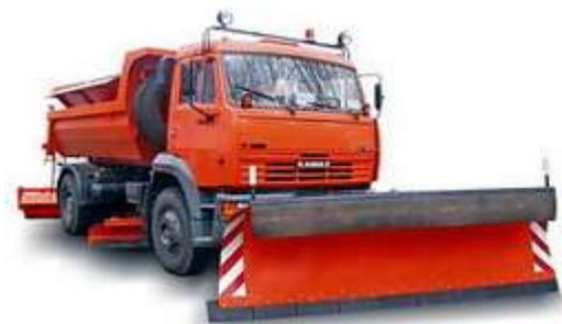
Универсальная комбинированная дорожная машина ДМК-60 представляет собой автомобиль-самосвал КАМАЗ-53605 (грузоподъемность 11 тонн, мощность двигателя 260 л.с.) с комплектом быстросъемного навесного оборудования для зимнего содержания автодорог, а так же для перевозки сыпучих и прочих грузов.
