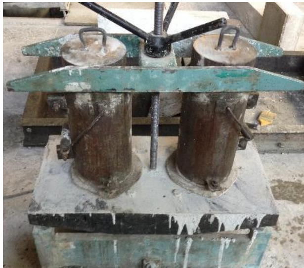
Рисунок 9 - Изготовление цилиндрического образца из смеси RCC с помощью вибростола
