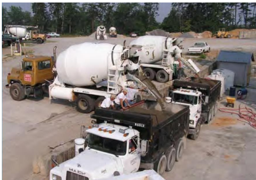
Рисунок 12 - Загрузка грузовиков из автобетоносмесителей
