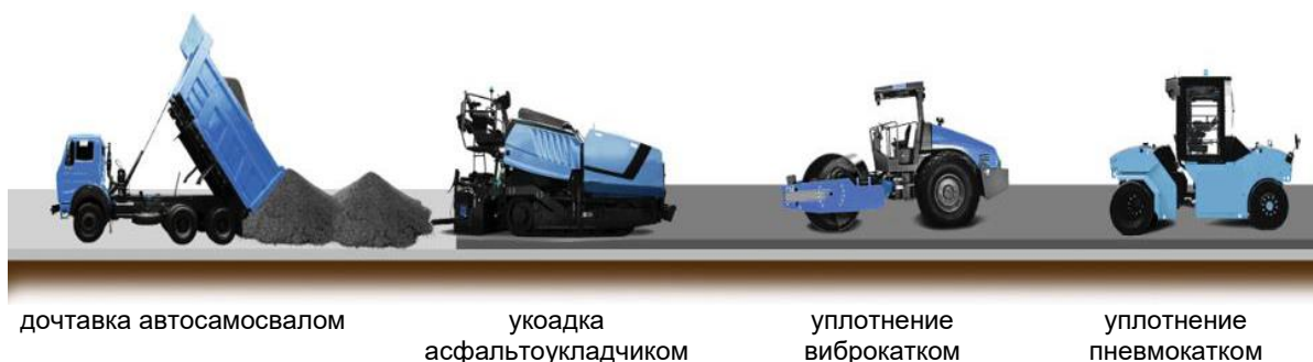
Рисунок 17 - Технологические операции по укладке RCC
