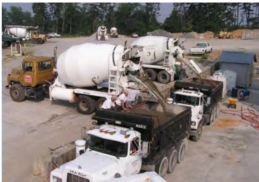
Figura 12 – Încărcarea camioanelor din autobetoniere
