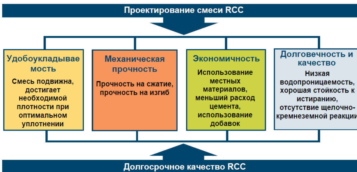
Рисунок 5 - Факторы, учитываемые при подборе смеси RCC
