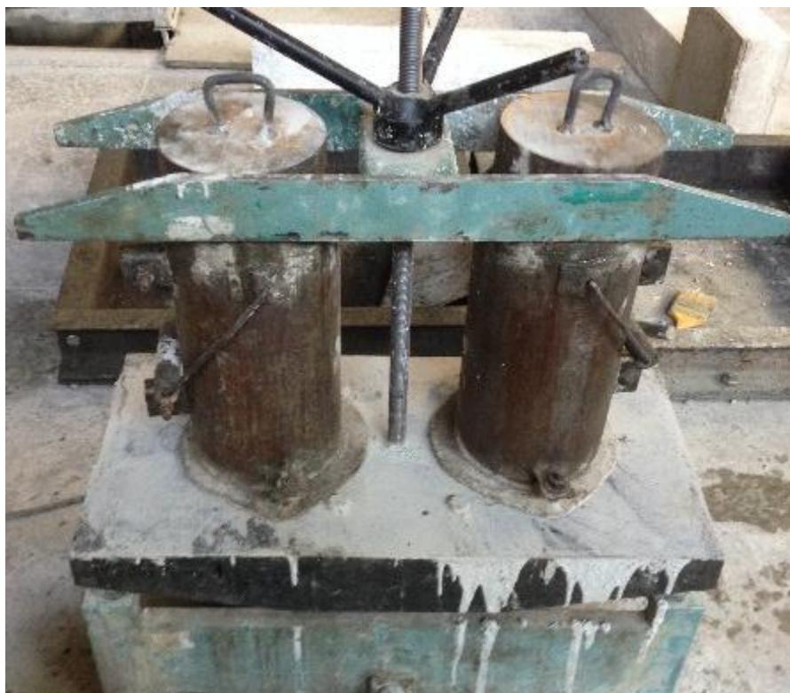
Figura 9 - Confecționarea epruvetei cilindrice din amestec RCC prin metoda mesei vibrante
