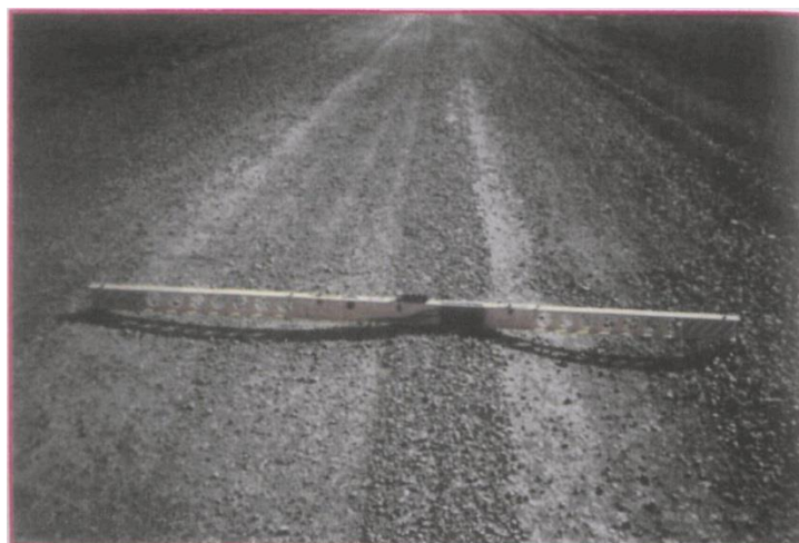
Figura 78 – Măsurarea făgașelor pe îmbrăcăminti de tip tranzitoriu
