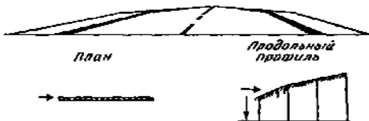
Рисунок 28 - Нарушение зрительной плавности дороги вертикальной кривой малого радиуса, создающей впечатление зрительного провала
