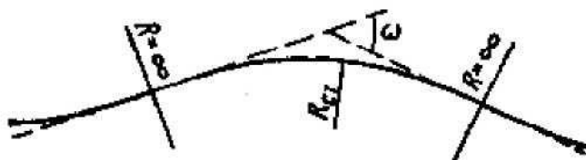
Figura 33 - Determinarea poziției și valorilor unghiurilor de virare a traseului în plan în cadrul trasării clotoidale
