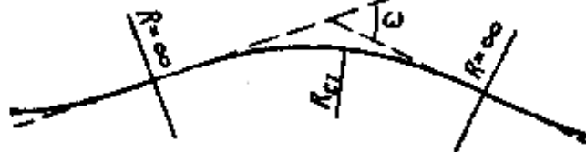
Рисунок 33 - Определение положения и величин углов поворота трассы в плане при клотоидном трассировании
