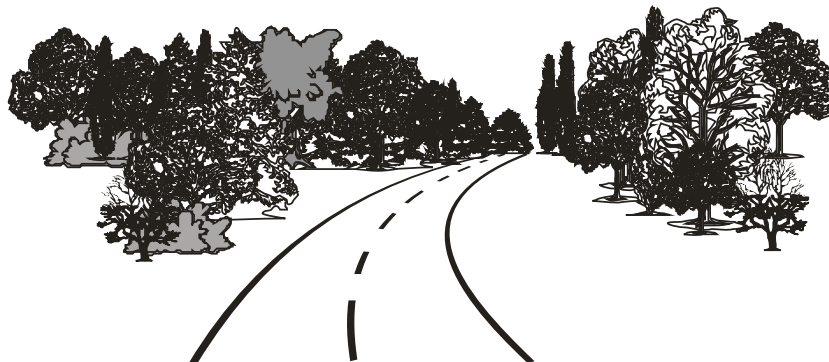
Рисунок А.12 - Кулисные группы деревьев и кустарника у входа дороги в лесной массив
