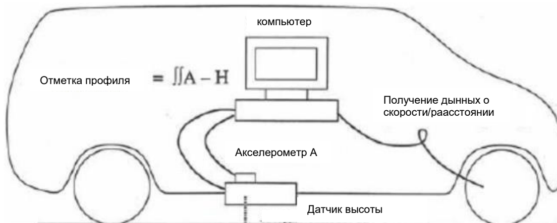
Рисунок 7 - Принципиальная схема системы акселерометрии
